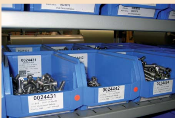
Het 2-bin systeem gevuld.
